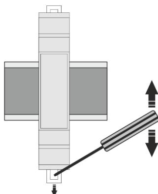
Zařízení je určeno k montáži do rozváděče na DIN lištu. Brána se na DIN lištu upevňuje pomocí plastových zámků, které jsou umístěny v horní a spodní části brány. Brána je dodávána včetně externí antény s 2 m dlouhým kabelem a magnetickou základnou, která se instaluje mimo rozváděč.
