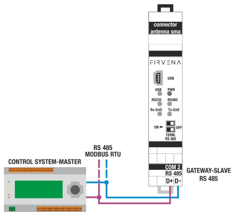
Poznámka: Pokud komunikace neběží po RS 232, RS 485, doporučujeme vyměnit dráty pro RS 232 (Rx za Tx) nebo pro RS 485 (D+ za D-) kvůli rozdílným označením výrobců řídicích systémů.
